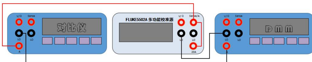
图 3.11 5502A、5522A 校准源电流检测接线图
