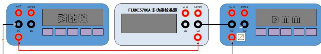
图 3.11 5700 系列校准源电压检测接线图
