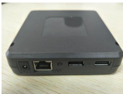
图 3.2 USB3.0 以太网服务器
