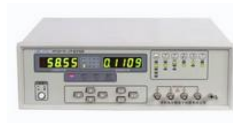
图 3.8 LCR 数字电桥
