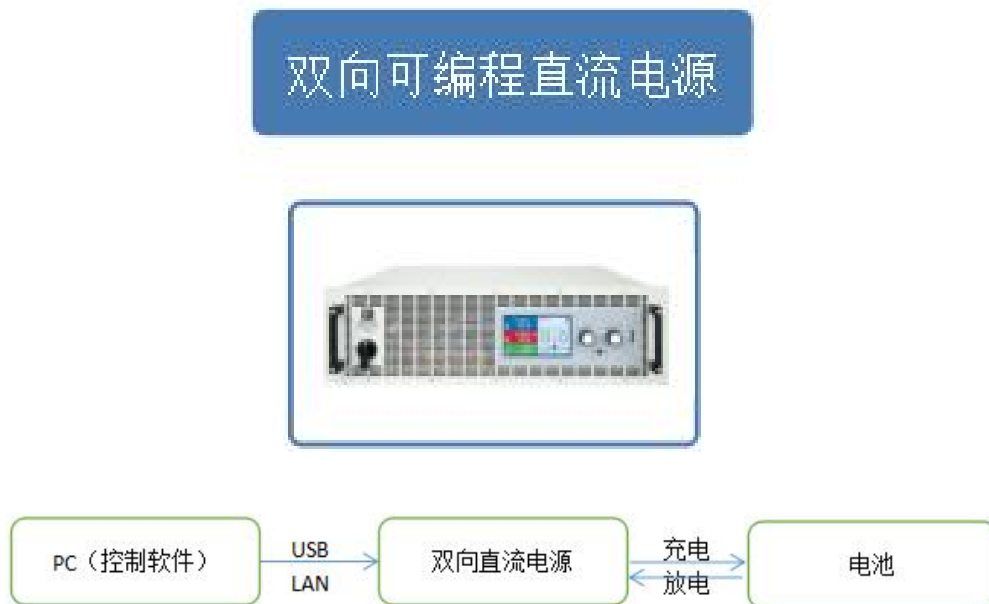
图 4.2 硬件与电脑的连接拓扑图
